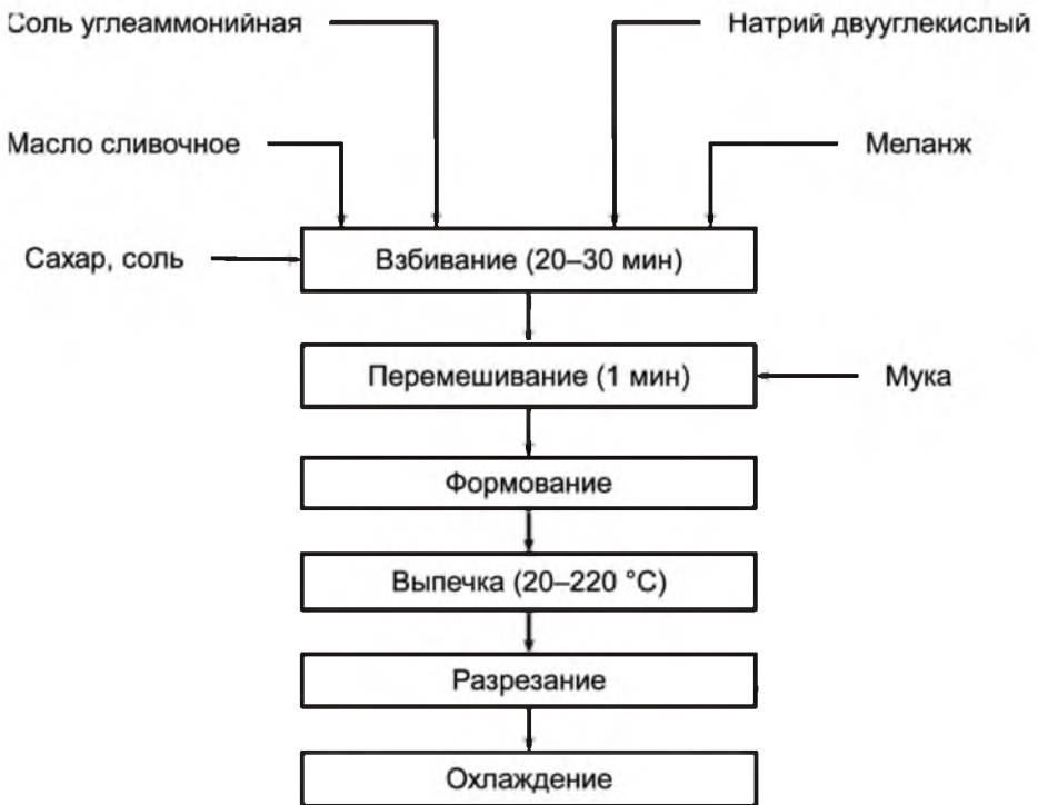
Рис. 6. Технологическая схема приготовления песочного полуфабриката на механизированной линии
