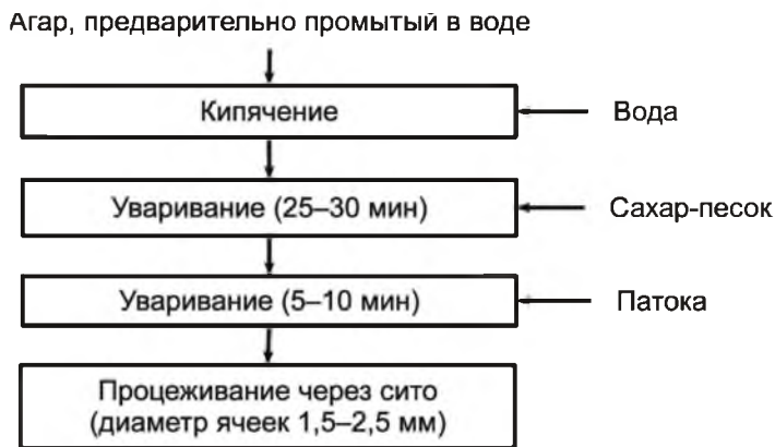
Рис. 21. Технологическая схема приготовления сахаро-агарового сиропа
