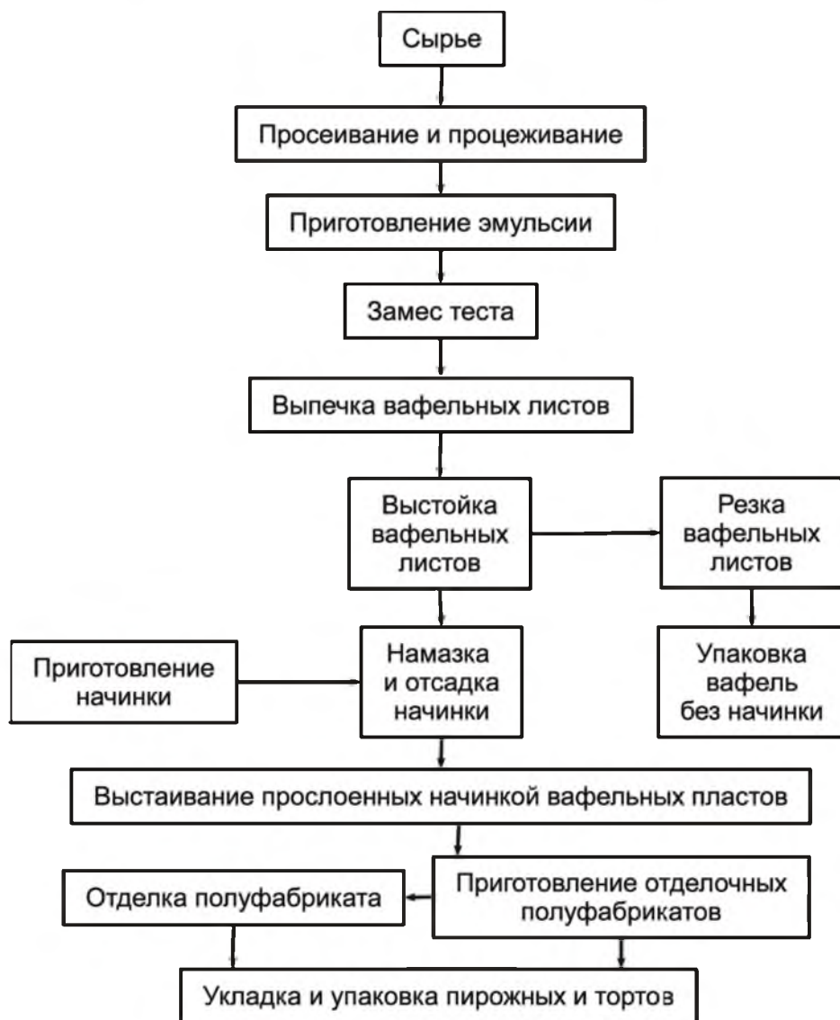
Рис. 42. Технологическая схема приготовления вафель
