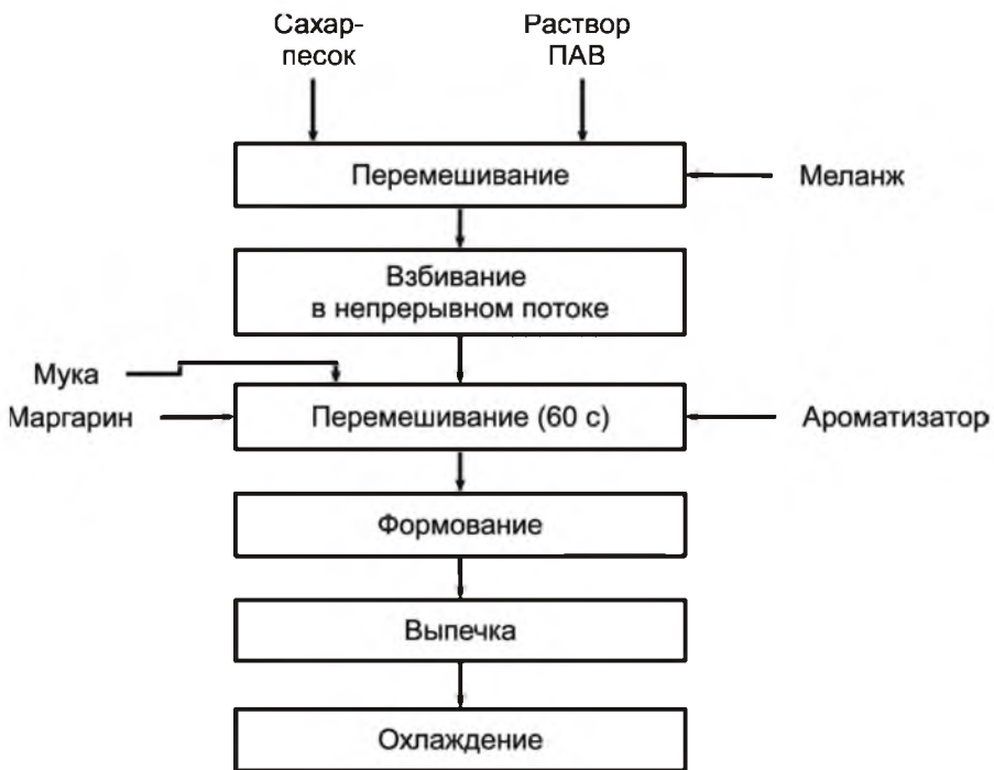
Рис. 5. Технологическая схема приготовления бисквитного теста с маргарином
