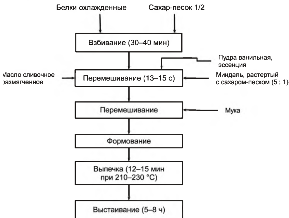
Рис. 12. Технологическая схема приготовления миндально-орехового полуфабриката
