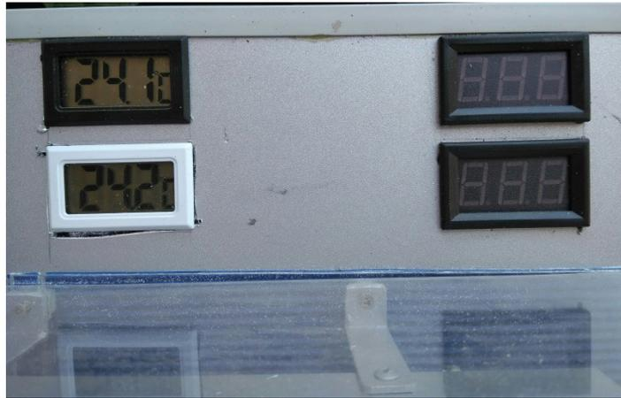
Исследования проведенные на действующем макете котла показали положительные результаты, при разности температур 700С четырьмя элементами ТЕС-127 ,было сгенерировано при напряжении 9,4В и токе 0,47А мощность 4,418 Вт.
