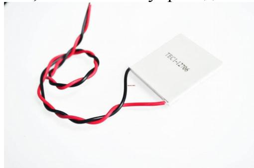
Данные модули в количестве 4 шт были установлены на макете газового котла при помощи нагревателей съэмитировали работу котла в реальных условия. В измерительной части установлены два цифровых термометра которые меряют температуру на холодной и горячей стороне, а также вольтметр и амперметр которые показывают электрические параметры в зависимости от разницы температур.
