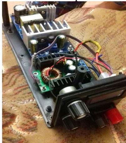
Для определения характеристик ИБП и ТБП была собрана специальная установка, потребляемая мощность определяется как произведение тока и напряжения
